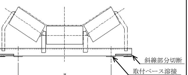
吊下げ式計量架台
